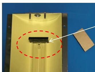
ラバーは交換用殺菌ランプ箱に説明書と同封されています。シールを剥がし粘着面をランプのトップに張り付ける。
