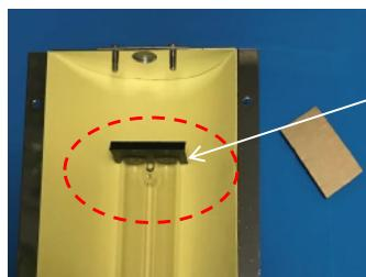
ラバーは交換用殺菌ランプ箱に説明書と同封されています。シールを剥がし粘着面をランプのトップに張り付ける。
