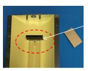
ラバーは交換用殺菌ランプ箱に説明書と同封されています。シールを剥がし粘着面をランプのトップに張り付ける。ランプを抜くときランプボックスへの衝撃軽減、又破損防止の為のラバーです。使用後は交換したランプとともに廃棄してください。
